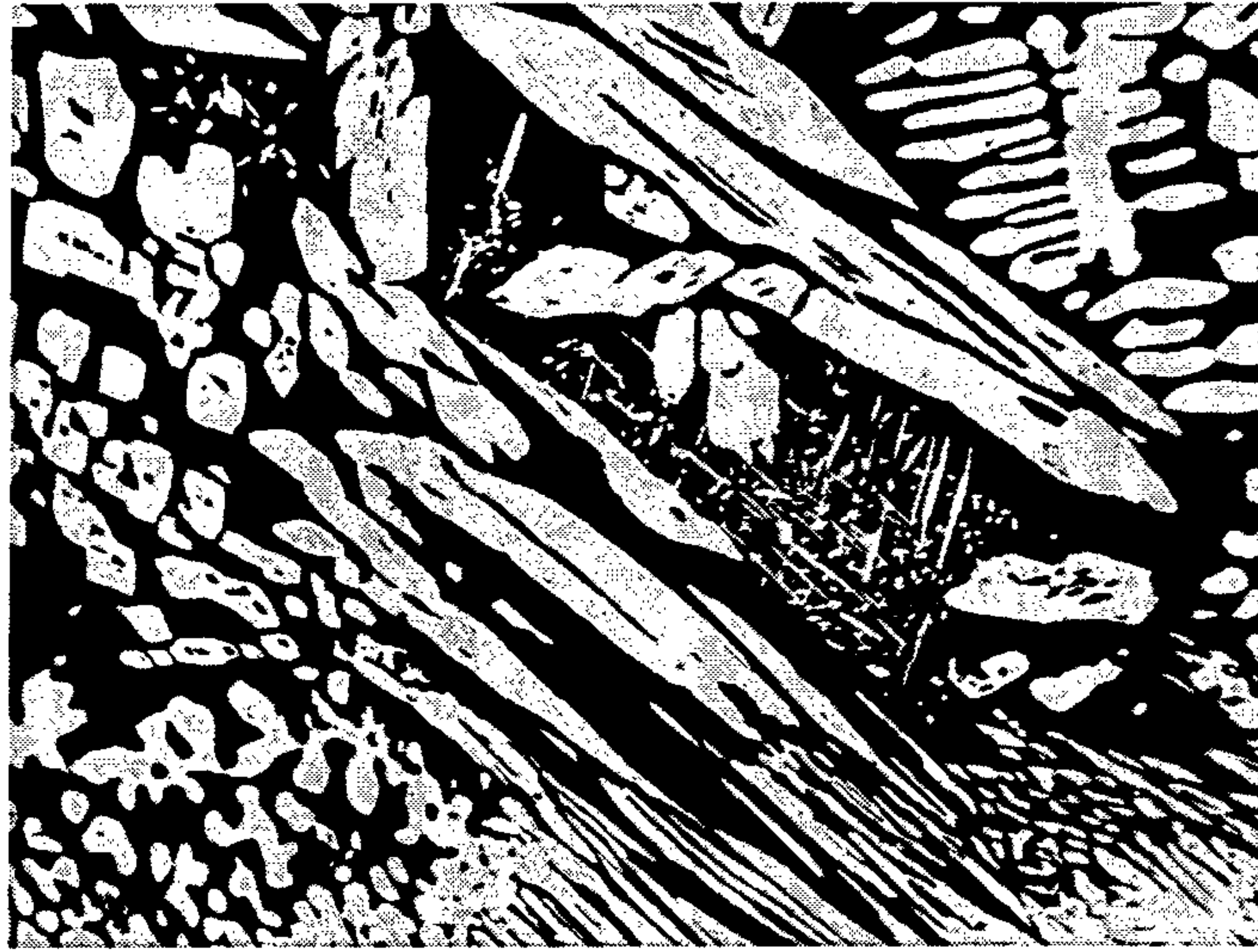
图 A.6 (铁素体+奥氏体)双相不锈钢中铁素体 200×
