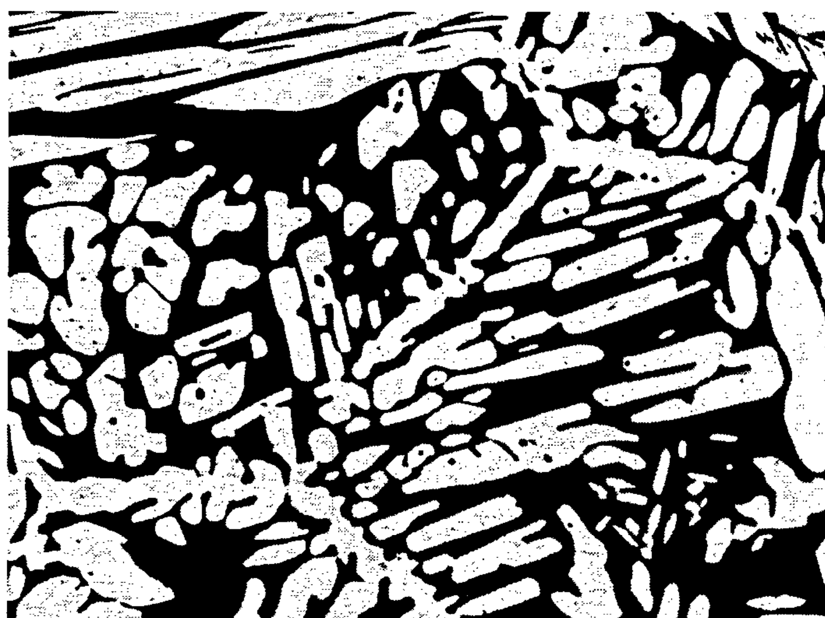
图 A.5 (铁素体 + 奥氏体) 双相不锈钢中铁素体 200 ×
