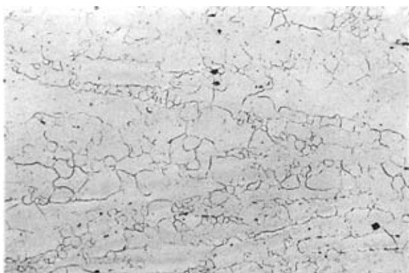
图3 AZ41M 型材纵向热挤压组织 2号浸蚀剂浸蚀 ×200
