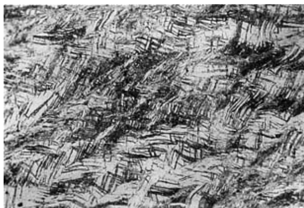
图1 ME20M 板材纵向冷轧组织 2号浸蚀剂浸蚀 ×200
