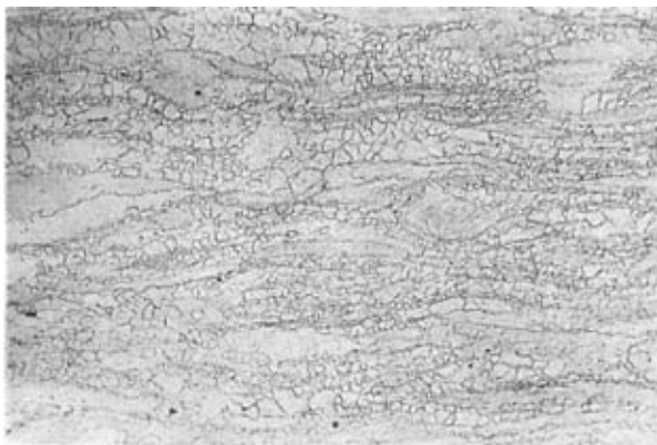
图4 ZK61M 模锻件纵向热变形组织 2号浸蚀剂浸蚀 ×200
