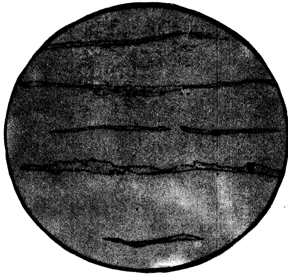
图 A3 1.5 级 \alpha -相面积含量 >5\% \sim 8\%
