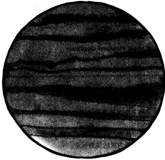
图 A6 4.0 级 \alpha -相面积含量 >20\% \sim 35\%
