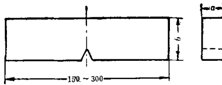
图 1 钢材断口试样示意图 a —试样厚度， b —试样宽度
