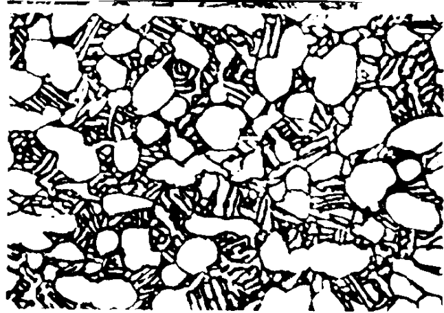
(d) 材料: TC4 锻件 状态: 初生 \alpha + 转变 \beta 浸蚀剂: HF:HNO 3 :H 2 O = 1:2:47 放大倍数: 500 \times
