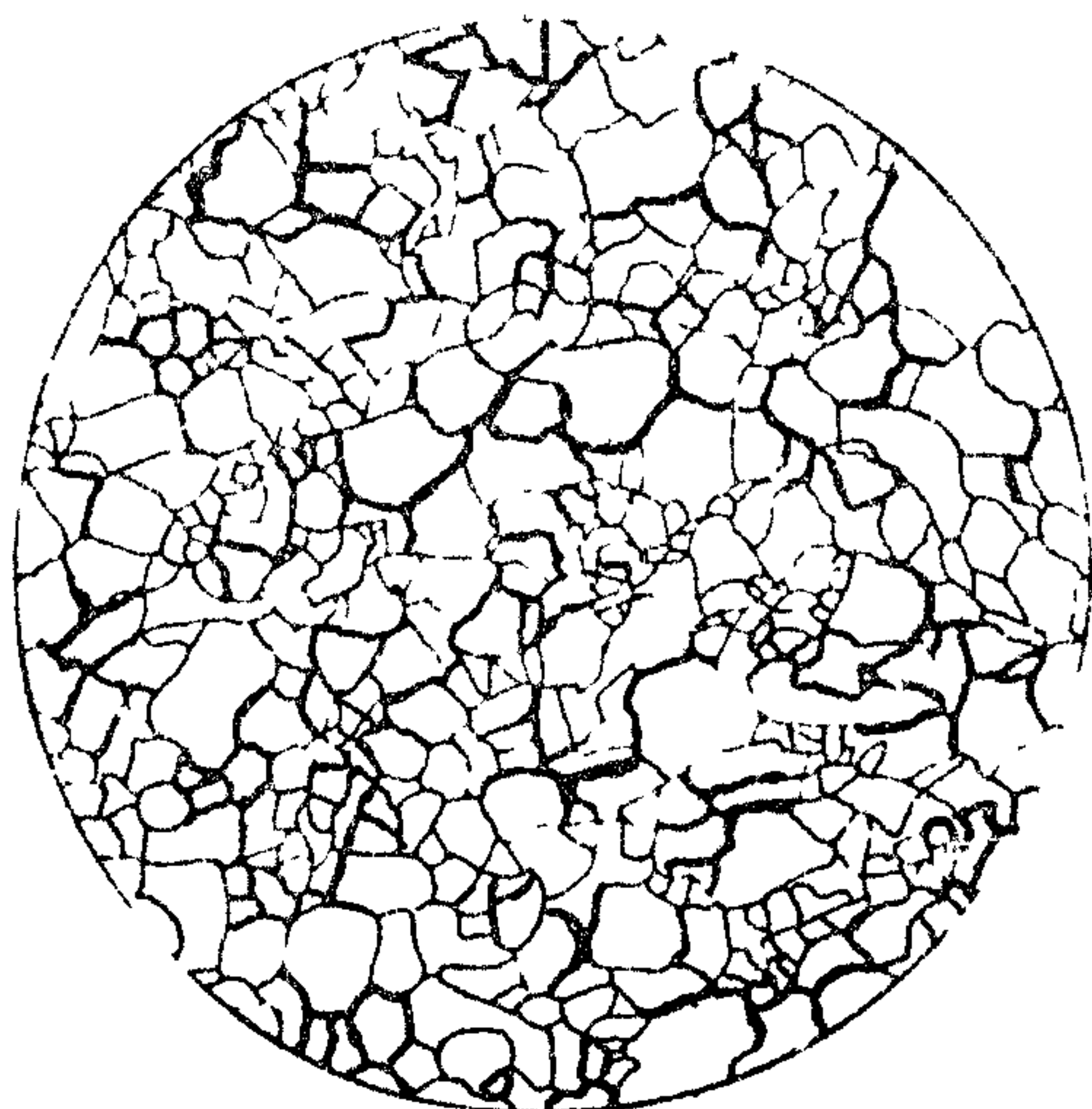
晶粒平均直径 20\mu\text{m} 晶界反应量 8% 200×
