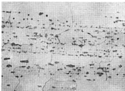
图 20 2A70(LD7)合金锻件淬火过烧组织 3号浸蚀剂浸蚀 ×200
