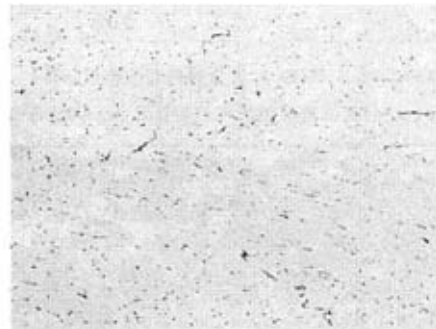
图9 1060(L2)铝铸轧板纵向显微组织 3号浸蚀剂浸蚀 \times 200
