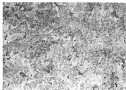
图 15 2A12(LY12)合金棒材淬火正常显微组织 3号浸蚀剂浸蚀 ×250
