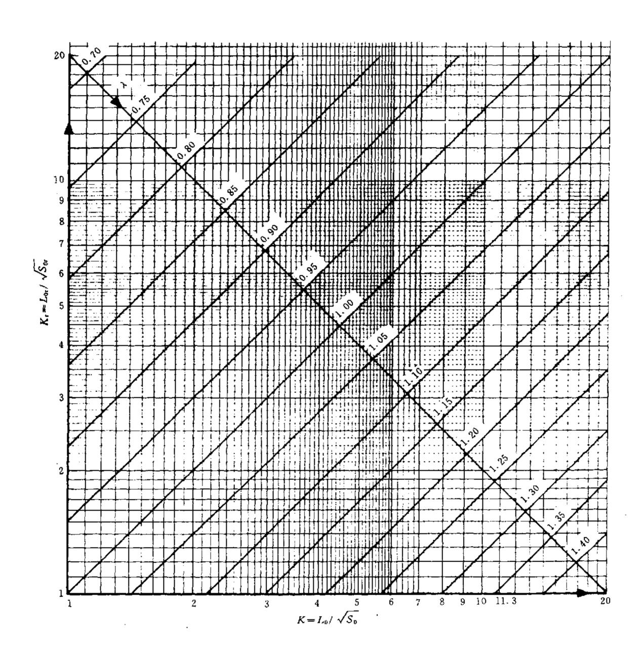
图 5 各类型试样的比例系数 K、K. 与换算因子  $\lambda$  的关系
