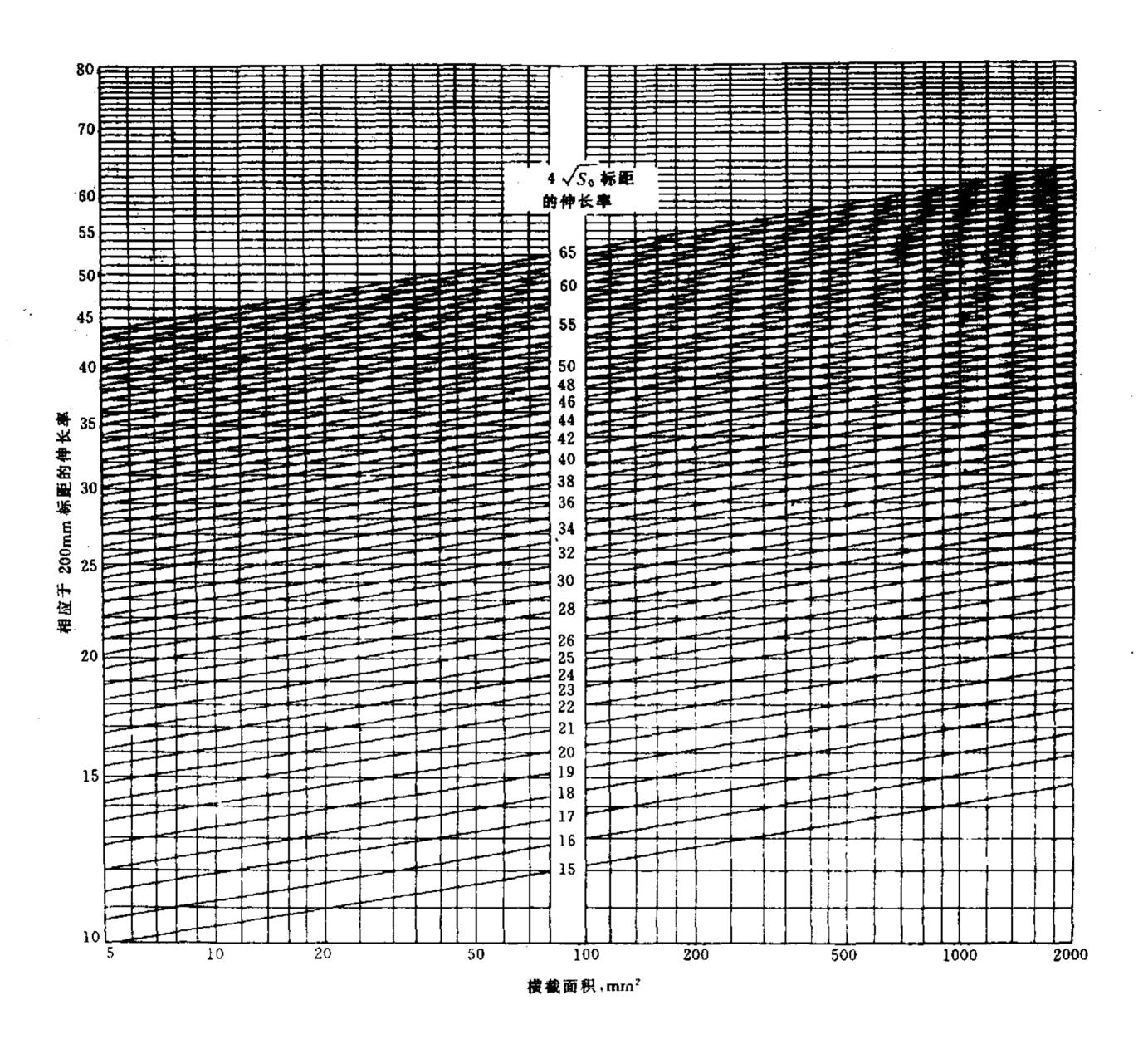
图 4  $\sqrt{S_0}$ 与 200 mm 定标距的伸长率的换算
