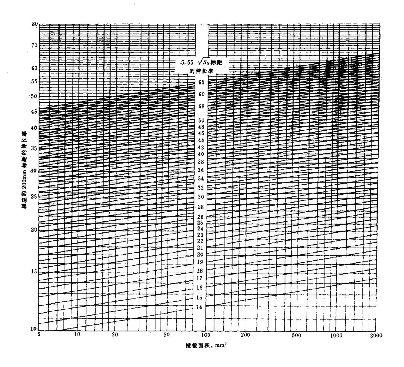
图 2 5.65  $\sqrt{S_o}$ 与 200 mm 标距的伸长率的换算
