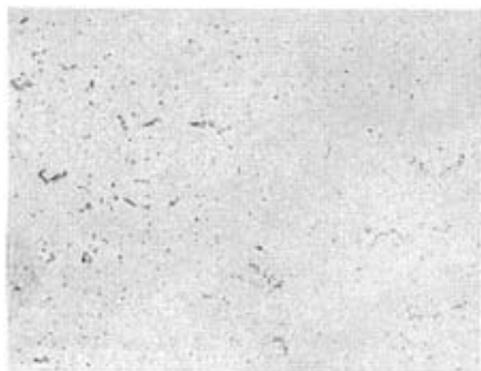
图 10 1060(L2)铝铸轧板横向显微组织 3号浸蚀剂浸蚀 ×200
