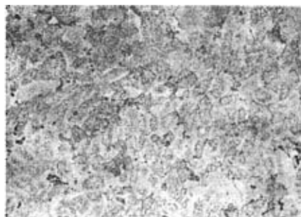
图 17 7A04(LC4)合金型材淬火正常组织 3号浸蚀剂浸蚀 ×250
