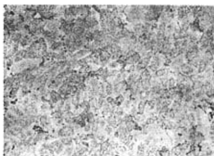
图 15 2A12(LY12)合金棒材淬火正常显微组织 3号浸蚀剂浸蚀 ×250
