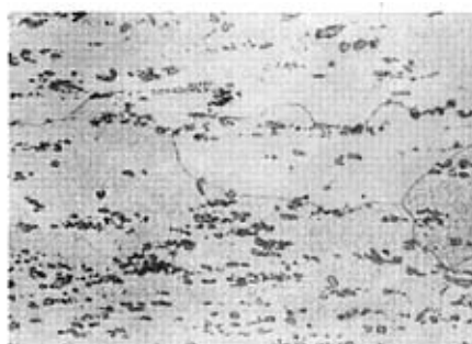
图 19 2A70(LD7)合金锻件淬火正常组织 3号浸蚀剂浸蚀 ×200
