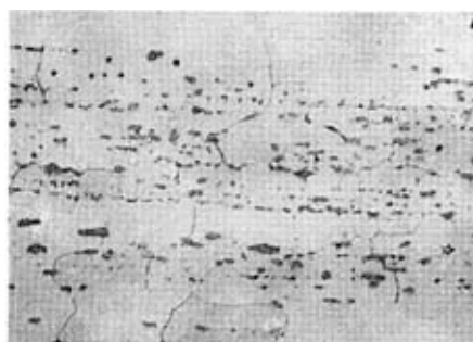
图 20 2A70(LD7)合金锻件淬火过烧组织 3号浸蚀剂浸蚀 ×200
