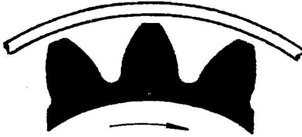
图 16 A 型：非齿廓型硬化
