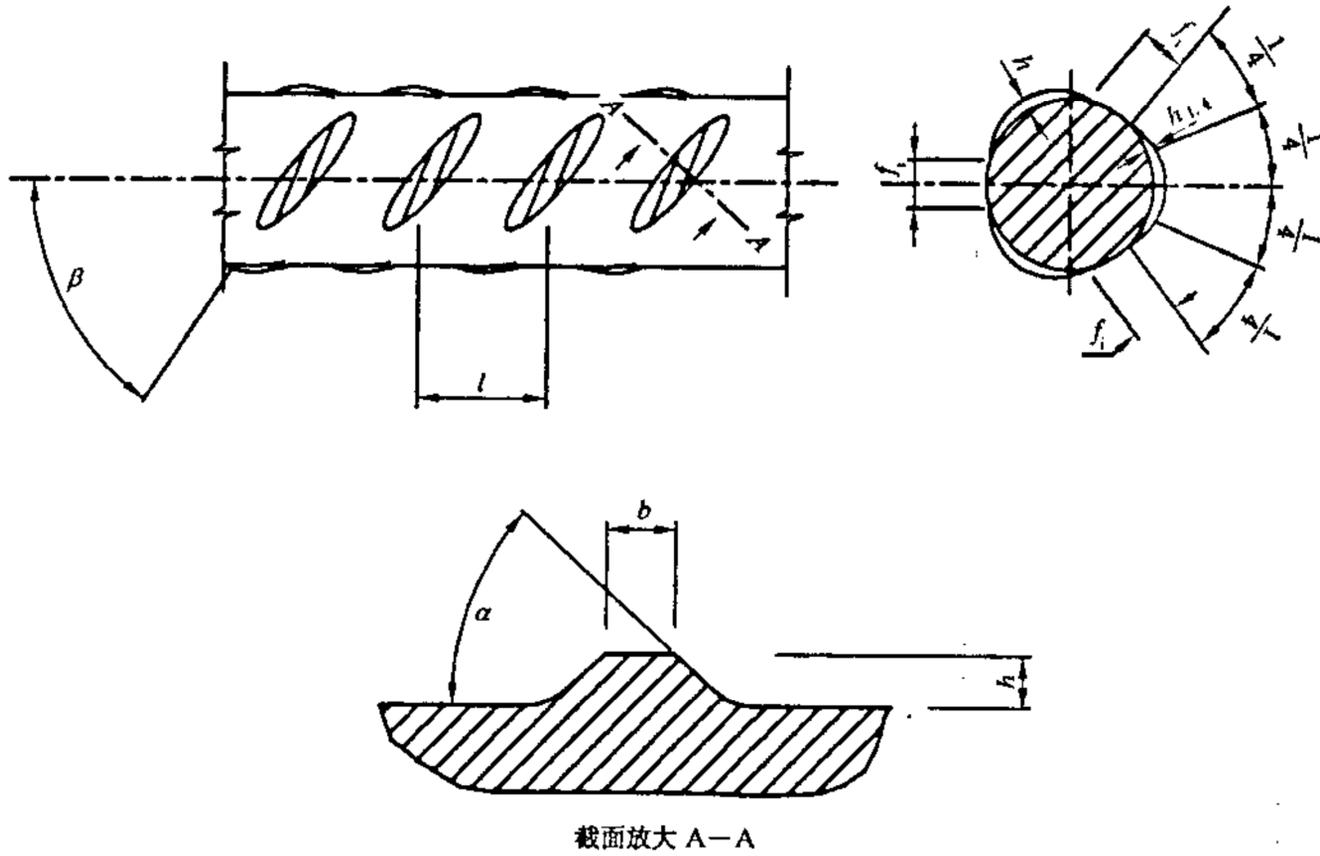
$\alpha$ —横肋斜角;  $\beta$ —横肋与钢筋轴线夹角;  $h$ —横肋中点高;  $l$ —横肋间距;  $b$ —横肋顶宽;  $f_i$ —横肋间隙
