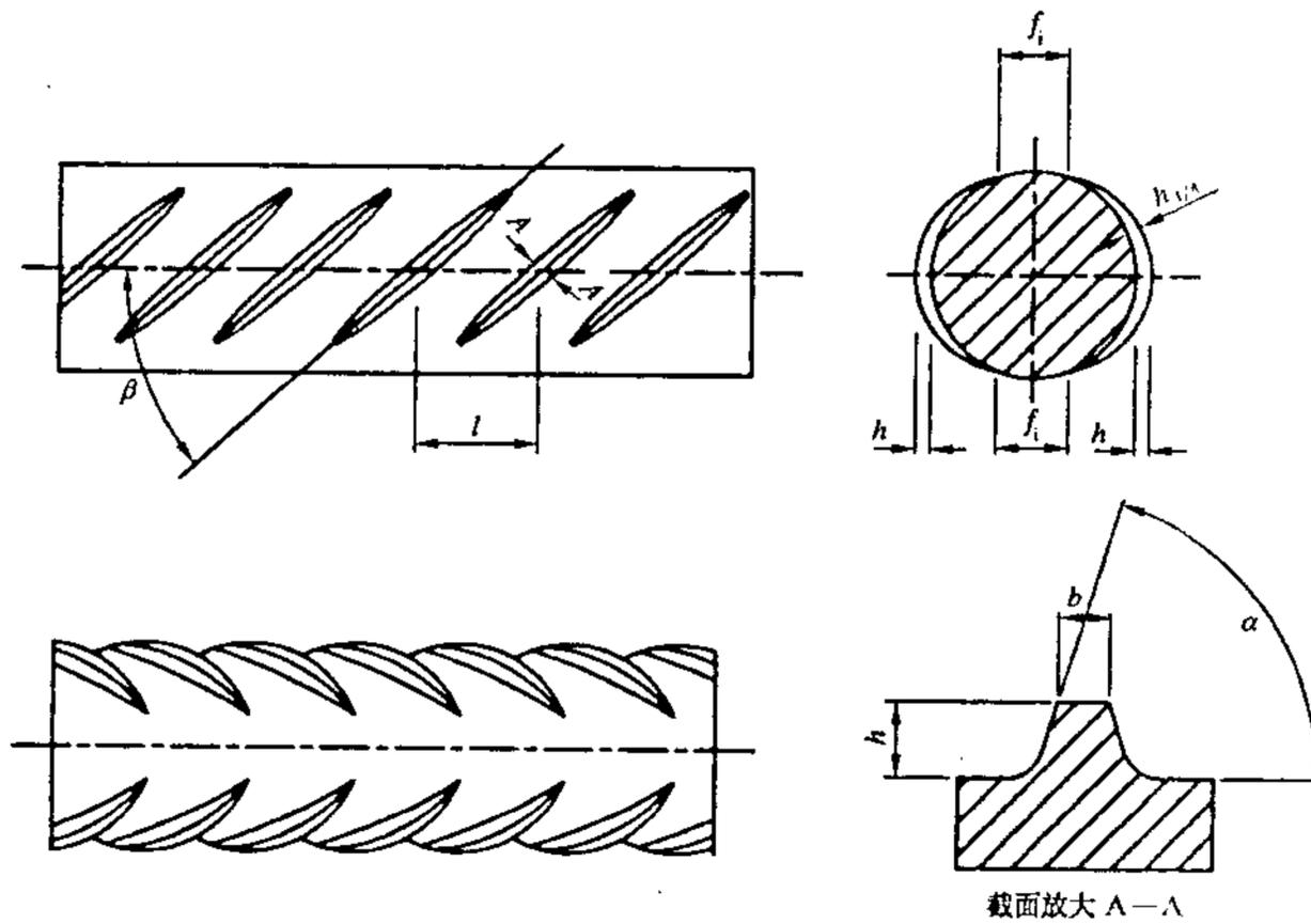
$\alpha$ —横肋斜角;  $\beta$ —横肋与钢筋轴线夹角;  $h$ —横肋中点高度;  $l$ —横肋间距;  $b$ —横肋顶宽;  $f_i$ —横肋间隙
