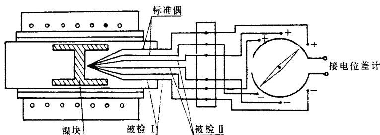
3.4.1 将被检热电偶捆扎在标准铂铑—铂热电偶周围，使工作端处于同一平面上，然后插入炉膛最高温度处，炉口用石棉绳塞紧；冷端处于同一平面上并插入冰点槽内，若不用冰点槽，须使各冷端点温度保持稳定。用水银温度计测出冷端温度，并按下式进行修正：
