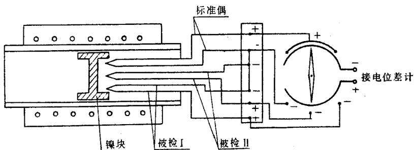
A.2 将捆好的热电偶束（各热电偶工作端互不接触，并位于同一平面上），插入炉内镍块（或耐热合金块）孔中，而不与镍块接触（如镍块孔底内填有绝缘材料，可直接插到底），然后按图联线，冷端温度不用修正，只要保持在同一温度下即可。待炉温恒定在检验点温度 $\pm 10^{\circ}\text{C}$ 时，即可进行测量。先测量标准热电偶热电势值 $E'$ （此值只作确定炉温是否在检验点温度 $\pm 10^{\circ}\text{C}$ 的依据），再依次顺序读取每一反串组的热电势差值 $\Delta e$ ，每组读数不少于2次。
