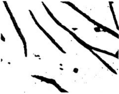
图 15 500× 灰铸铁中条状石墨
