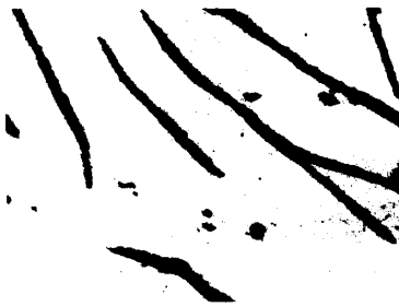
图 15 500× 灰铸铁中条状石墨
