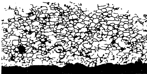
图 2 典型的晶间腐蚀照片
